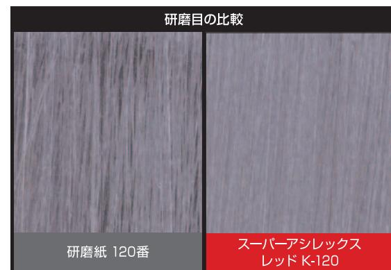
※写真はアルミ板を研磨し、比較しています
