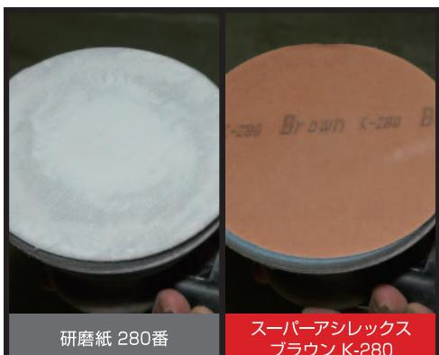
目詰まり・絡みが発生しやすいアルミ、銅などの非鉄金属や超高分子量ポリエチレンなどの樹脂およびパテ、プラスチック、ケルコートの研磨、およびマシニング加工後のワークにクーラントが付着した状態での研磨において、スーパー・アシレックス、スーパー・バフレックスは既存の研磨布紙とは違い、目詰まり・絡みが発生しにくいので、初期の切削力が持続し、耐久性良く使用できます。
